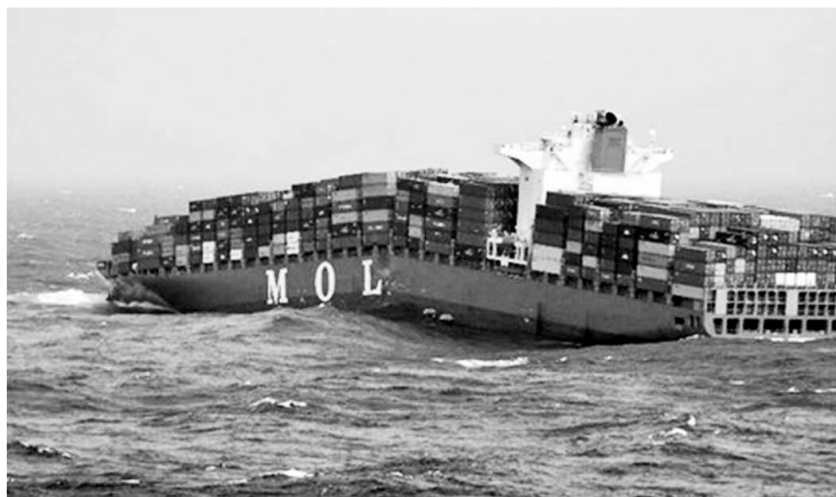
VLCV “MOL Comfort” ya fracturado (foto obtenida desde el “Yantian Express”)
