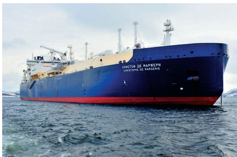
Buque de Transporte de GNL “Christophe de Margerie”, de casco reforzado para la NSR
