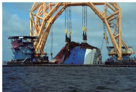
Izado de la Sección Uno, ya cortada por la VB-10.000 Versabar (Foto: gCaptain)
