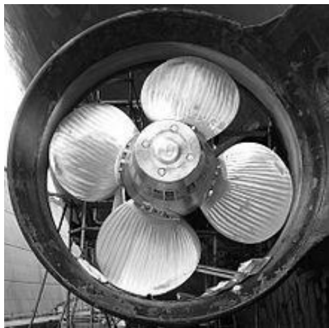
Hélice con tobera (Note la distancia entre la hélice y la tobera)
